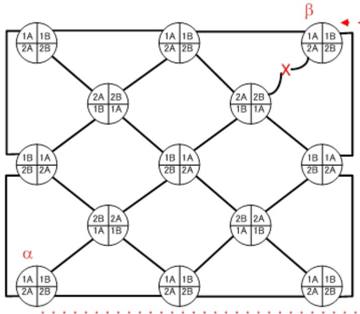
No caso de uma nova falha acontecer, neste caso considerando uma quebra do equipamento roteador FiberMesh no ponto "Y", o sistema criará uma outra rota otimizada conforme a seguir:
