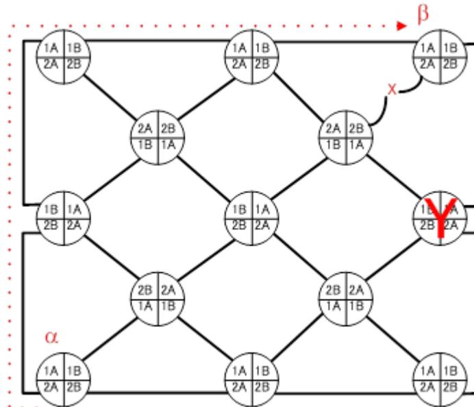
Agora se nesta rota houver queda de energia da fonte que alimenta o roteador FiberMesh, e este estiver equipado com o opcional de by-pass óptico (OPT Mirror) como no ponto "Z", será preservada a continuidade óptica entre os roteadores FiberMesh adjacentes mantendo a conexão de dados operacional conforme a seguir:
