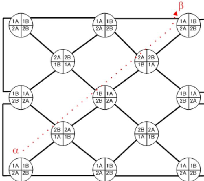
Se por algum motivo a fibra óptica é danificada no ponto “X”, o sistema detecta a falha e automaticamente cria uma nova rota conforme a seguir:
