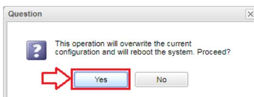
Após clicar em **Yes**, uma mensagem será exibida (**Configuration Backup Restored. Please re-login**) e a conexão com o equipamento será perdida. Será necessário aguardar o sistema reiniciar e logar novamente.
