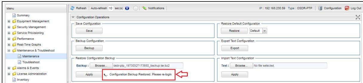
Após acessar o equipamento, primeiramente, clicar em **Maintenance & Troubleshoot** no **Menu** à esquerda, e na sequência clicar em **Maintenance**.
