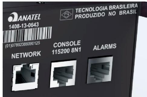
Figura 2 - Interface Serial (Console) do equipamento LD 2502
