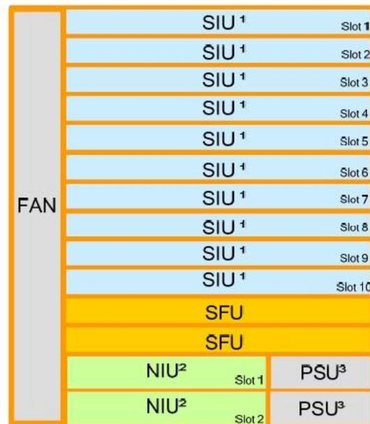
Figura 11 - Disposição dos módulos no chassi FK-OLT-G2500
